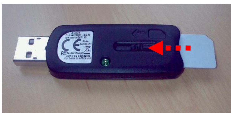
Figure 3 Insertion de la puce dans le support
